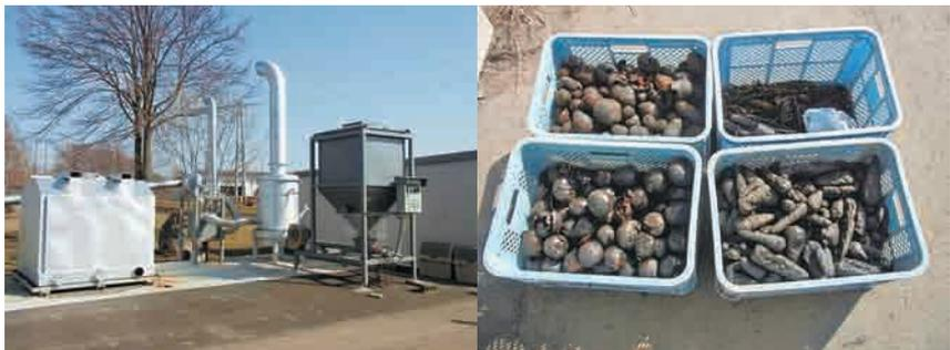
郊外に設置された製炭炉と規格外野菜を原料とするバイオ炭（美幌町）
