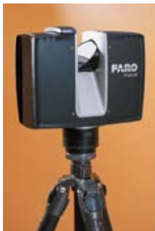
▲ 3Dスキャナー計測により、立体データ化し可視化することができる
