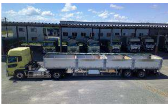
特注架装をしているトレーラー（左）とトラック（右）。荷台に仕切りが設けられており、トレーラーは最大 4 品目、トラックは最大 3 品目を同時に輸送することができる。
