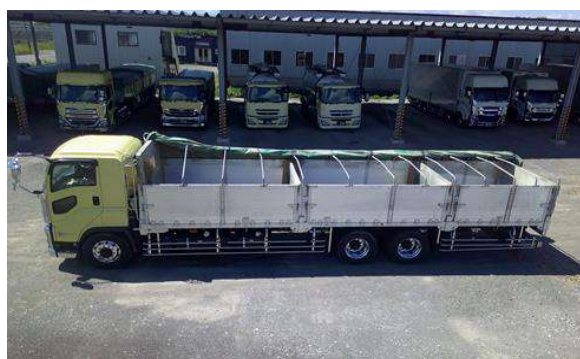
特注架装をしているトレーラー（左）とトラック（右）。荷台に仕切りが設けられており、トレーラーは最大 4 品目、トラックは最大 3 品目を同時に輸送することができる。
