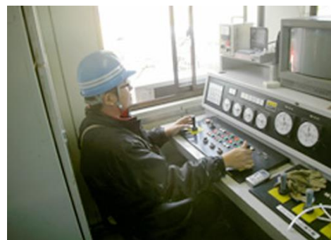
▲ 電力会社の取水路での浚渫工事の様子。 水中排砂ロボットを用いた浚渫工事は、遠隔操作により行われる。
