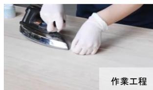
← 突板の繋ぎ目の隙間を埋める作業。一般的にはパテで埋められるが、広葉樹合板では同じ木材で埋めることにこだわること、つなぎ目が分からない高品質な合板に仕上げることが可能となる。
