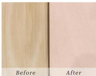
← 化粧板の製造ではベースとなる基材に各種単板を貼るが、仕上げ材は約0.2mmと薄いため、そのままでは下地の色や凹凸が透けて見える。広葉樹合板では、下地処理としてコーティングを行い、均一な色や平面にしてから仕上げ材を貼ることで、手間暇は掛かるが、厳しい材料基準にも対応可能となっている。
