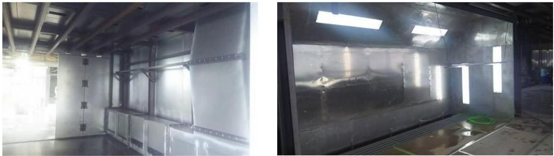
▲2017年に更新した焼付窯（左）と塗装ブース（右）。更新により炭素繊維プラスチックの塗装に対応した。
