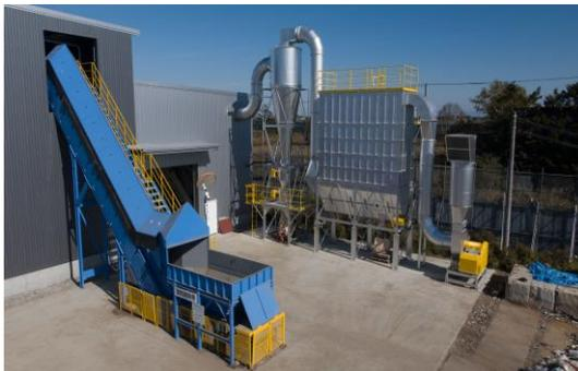
■ 破碎・固形燃料製造施設の例
