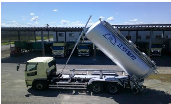
バルク車（左）は製粉後の小麦粉を輸送。エア式排出システムにより人の手を使わず製品輸送が可能。ウイング車（右）は袋詰めされた製品（小麦粉）を輸送する為に活用している。
