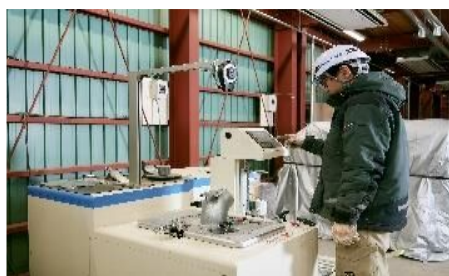
■パイプシェーバーの機械
