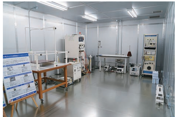
図6. シールドルーム
