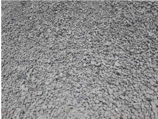
▲コンクリート再生骨材
