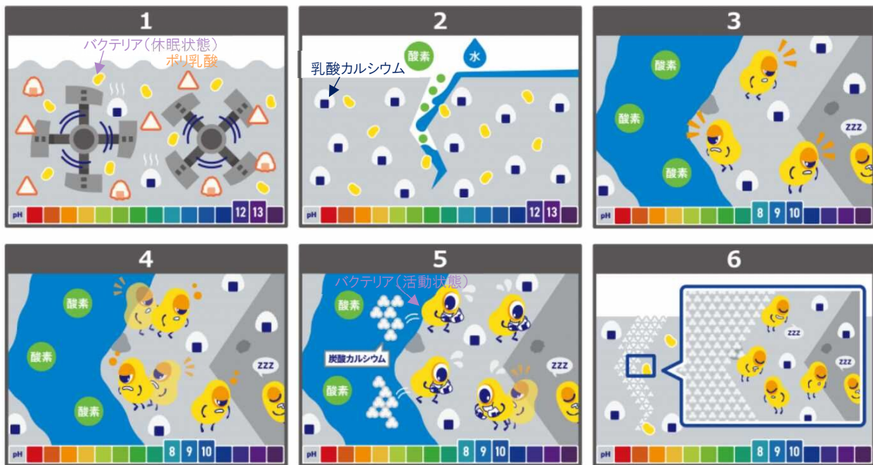
図 4：Basilisk による自己修復の仕組み 9
