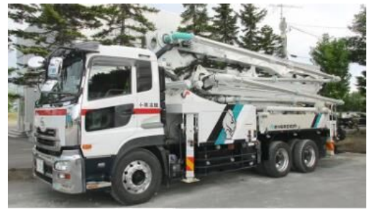
▲コンクリートポンプ車(30m)
