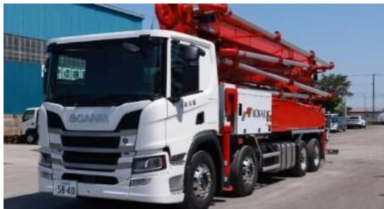
▲コンクリートポンプ車(43m)
