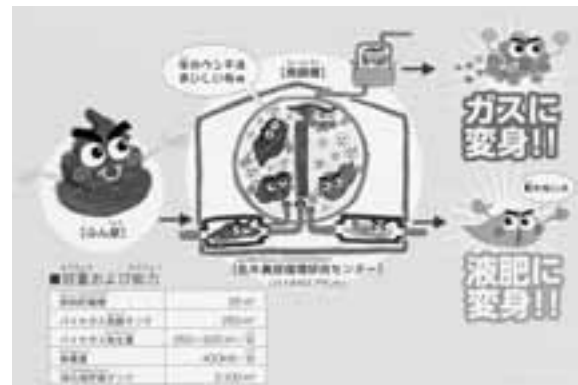
図表16 酪農学園大学のバイオガスプラント （資料：酪農学園大学パンフレットより）
