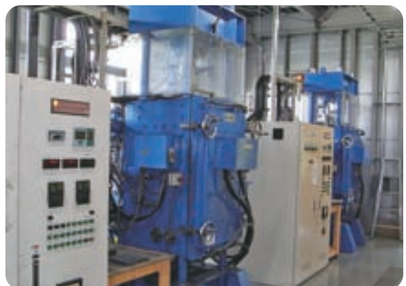
【ホットプレス（真空1,000℃）】 銅とモリブデンを多層に接合する装置
